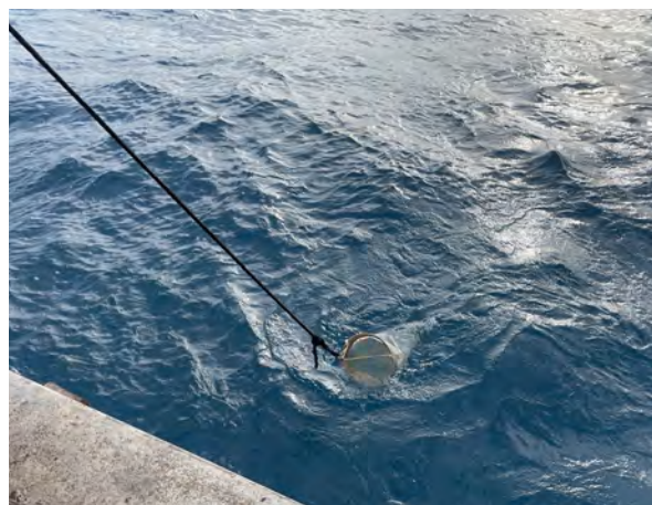
Rede de arrasto utilizada na metodologia de coleta de plânctons no Monitoramento de Biota Aquática do Porto do Pecém. Fonte: MRS Ambiental.
