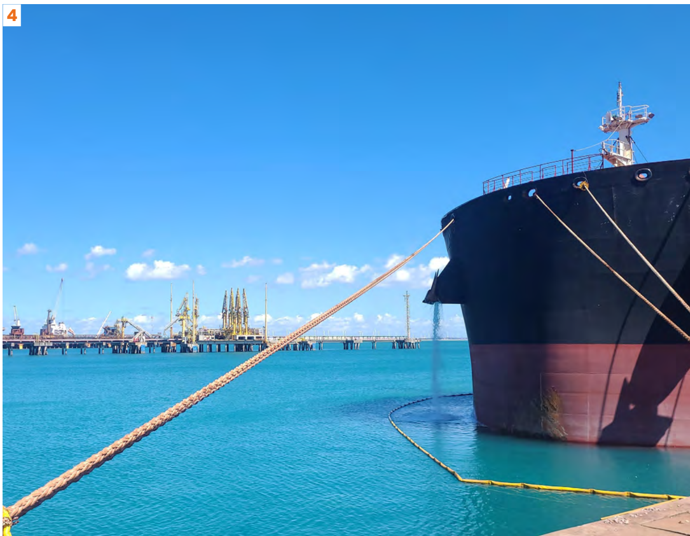
1. MonitorAr: blitz de fumaça preta com aplicação da Escala de Ringelmann; 2 e 3. Equipamentos Hivols utilizados no monitoramento da qualidade do ar (PTS, PM_{10} e PM_{2,5} ); 4. Cerco preventivo utilizado em operações de carga a granel e em rotinas de abastecimento. Fonte: MRS Ambiental.
