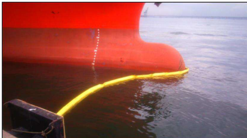
Foto 7: Barreira de contenção do tipo SeaFence flutuante ao redor do navio.
