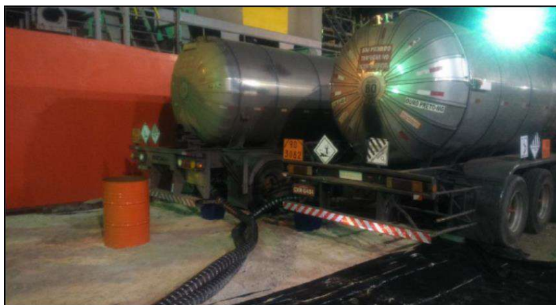
Foto 3: Caminhões estacionados, mangotes conectados e baldes posicionados.
