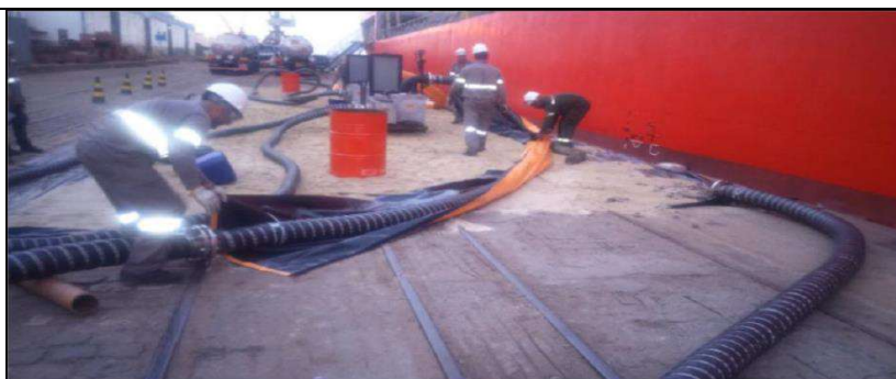
Foto 4: Encapsular mangote com lona adaptada com velcro.
