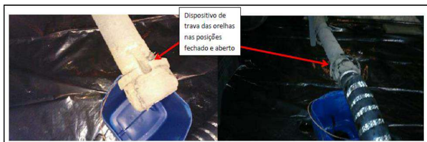
Foto 5: Dispositivo de segurança na extremidade do mangote. Trava orelha.
