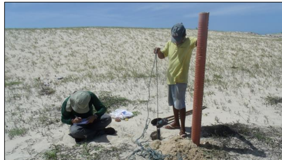
Figura 20 - Coleta de sedimentos do Aquífero Dunas e medida de nível estático e parâmetros físico-químicos in situ .
