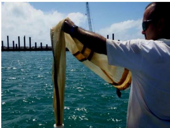
Figura 3 – Rede cilindro-cônica de malha 200µm. Fonte: Acquaplan, 2016.
