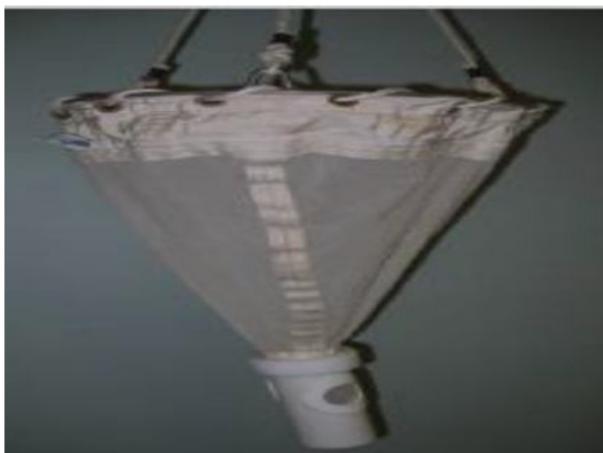
Figura 1 – Rede de coleta de plâncton cônica para análises qualitativas. Fonte: Acquaplan, 2016.
