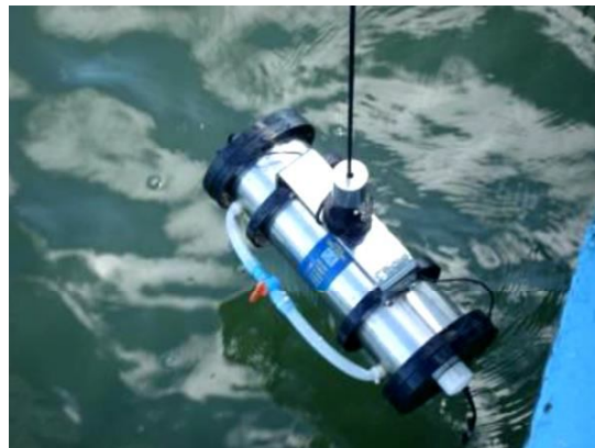
Figura 2 – Garrafa de Van Dorn para análises quantitativas. Fonte: Acquaplan, 2016.
